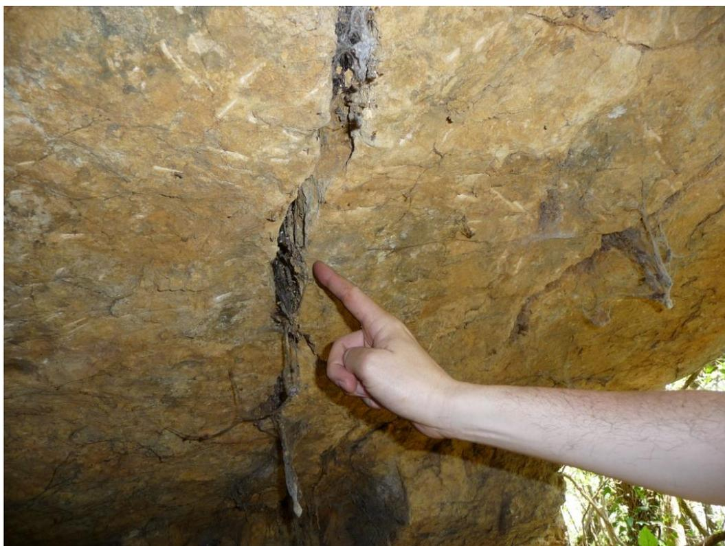
**Photo 4 : Présence de racines dans les fractures**
